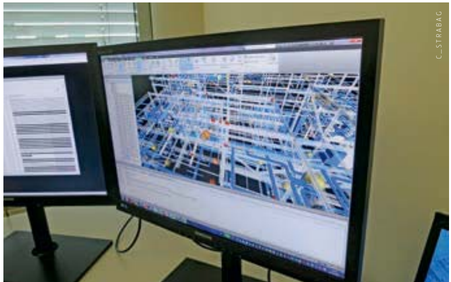
Eine der wesentlichen Hausaufgaben, die mit digitaler Planung gut zu lösen sind, ist das frühzeitige Auffinden von Planungskonflikten, Fachausdruck Clash Detection. Jeder der bunten Bälle auf dem Bild steht für einen Konflikt.
